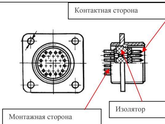
**контактная сторона** части электрического соединителя
