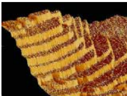
Полученное с помощью атомного силового микроскопа изображение ступенчатой структуры материала с шагом в 1/2 и 1 размер элементарной ячейки
