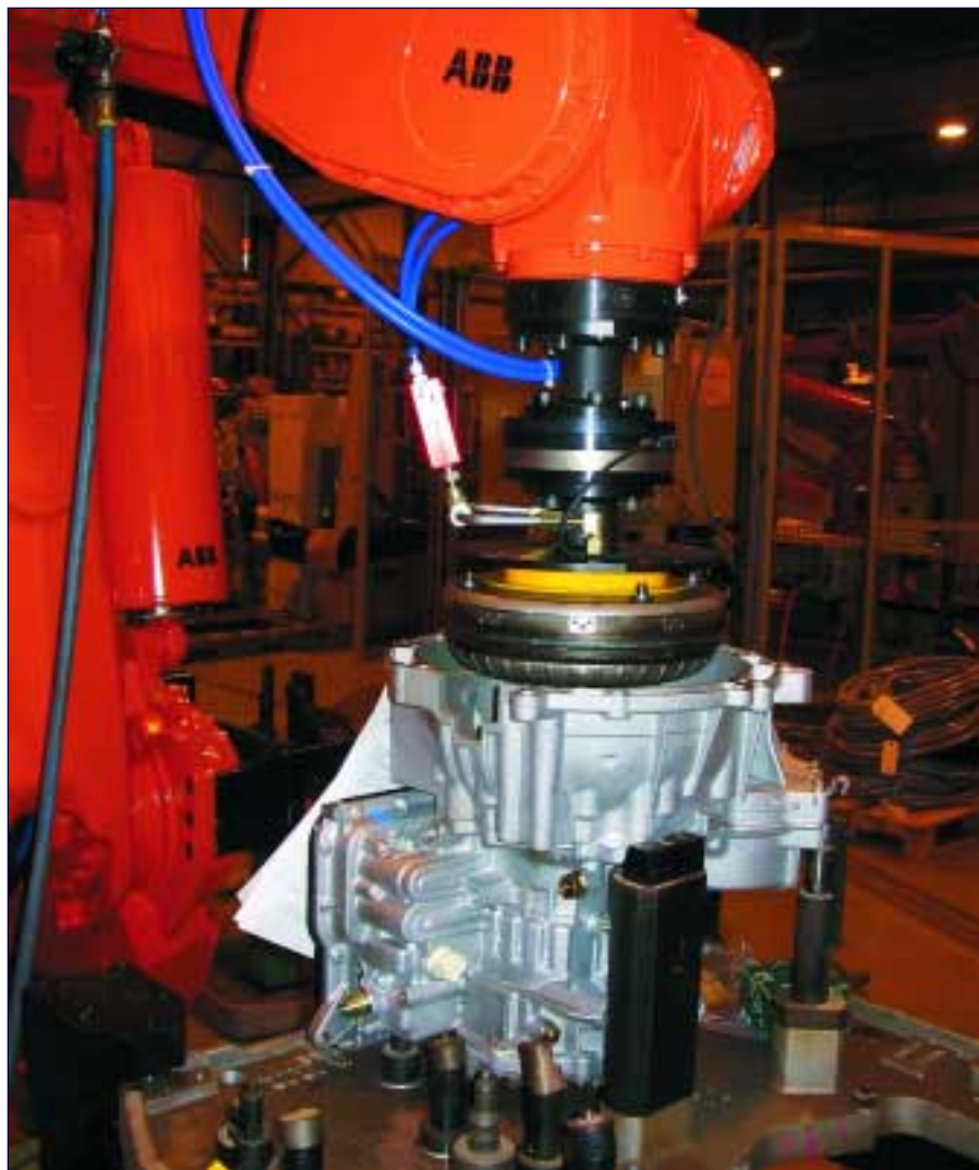
1 Робот серии IRB6400 с управлением по усилию выполняет сборку гидротрансформатора
