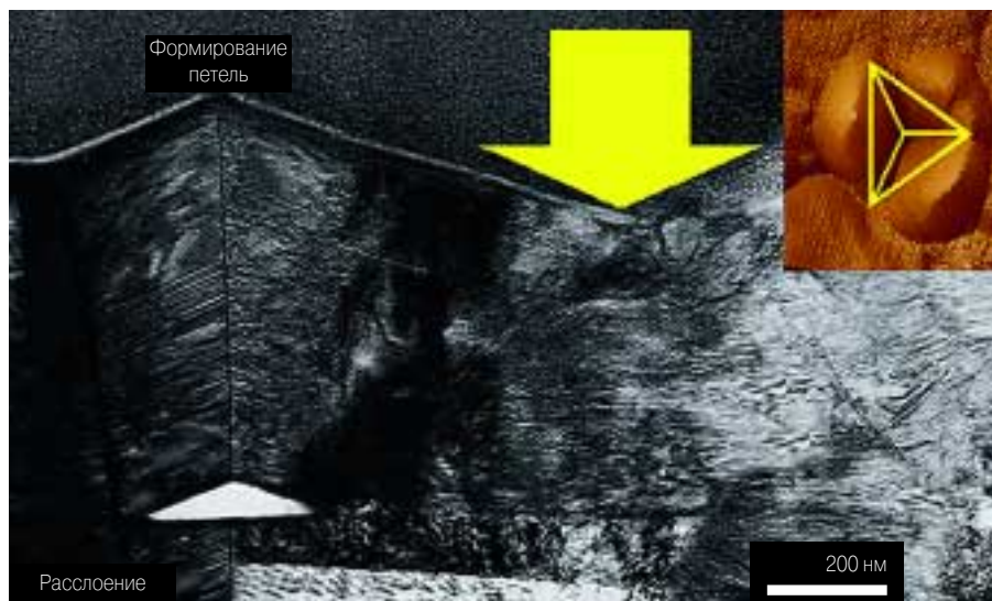
Изображение монокристаллического слоя MAX-фазы толщиной около 1 мкм после нано-индентирования (место указано стрелкой). Формирование крупных выступов характерно для материалов с высокой ковкостью. Фото: Я.Эммерлих и Х.Молина-Альдарегия, Университет Линкёпинга
