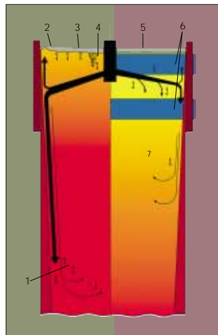
2 Поток в непрерывно отливаемой полосе без FC Mold (слева) и с FC Mold (справа)
