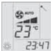
Отображение на дисплее данного символа показывает, что идет передача сигнала с пульта дистанционного управления на агрегат.
