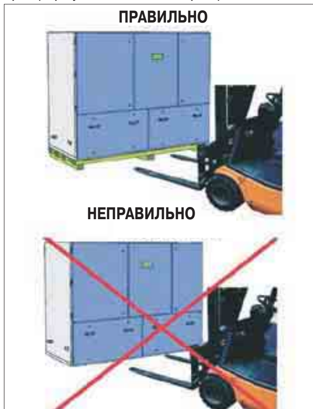
Рис. 6-2. Выгрузка агрегата при помощи вилочного автопогрузчика или крана (на рисунке показан типовой агрегат)
