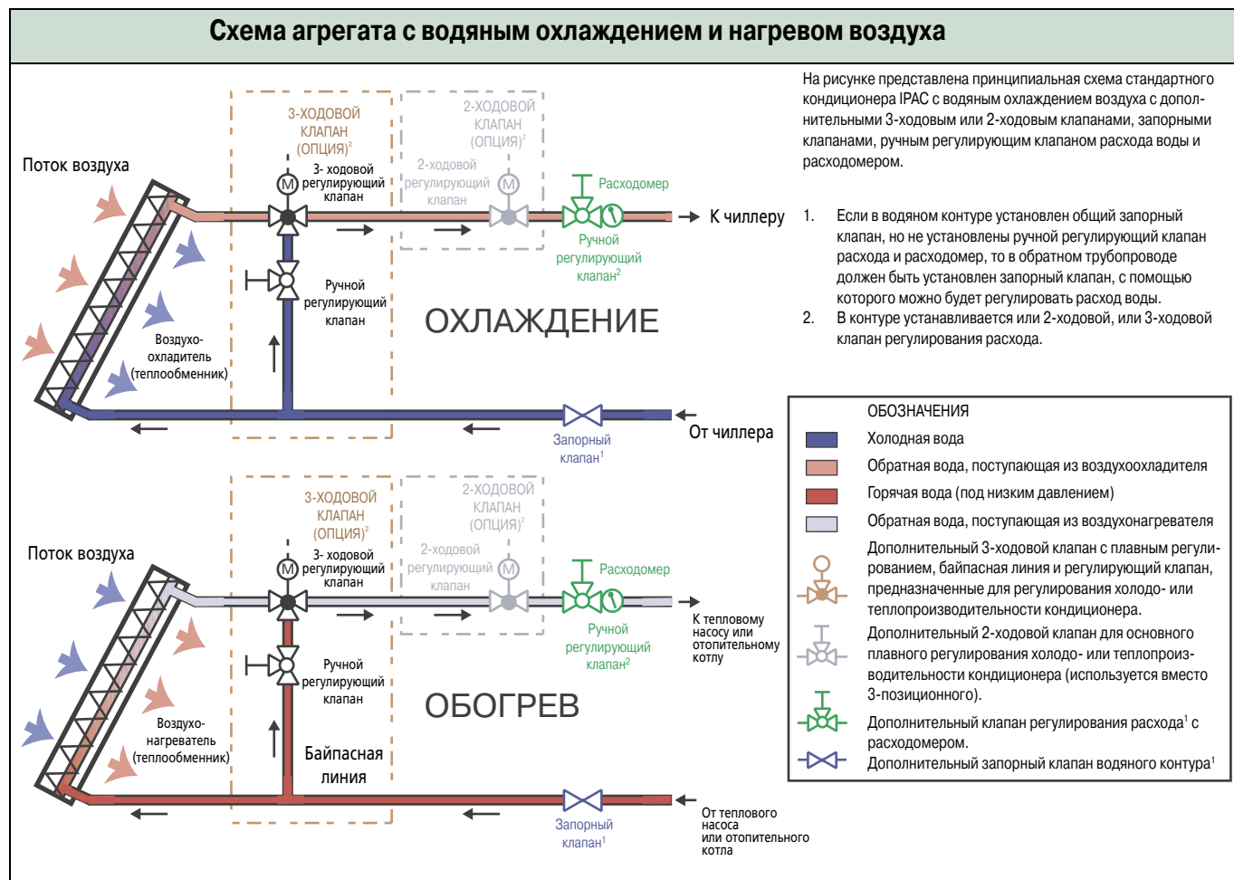
Рис. 2-6. Схема агрегата с водяным охлаждением и нагревом воздуха
